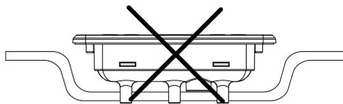
Le dos du in.k300 ne doit pas être logé dans un espace où l'eau peut s'accumuler, mais être laissé découvert.
