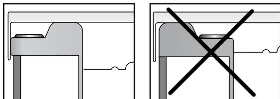
Le in.k300 doit être installé sur le bord extérieur du spa afin de ne pas l'exposer à l'humidité emprisonnée par le couvercle.
