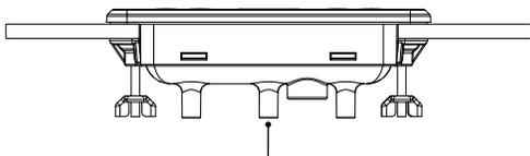
Les trous d'aération situés au dos du clavier ne doivent pas être obstrués.
