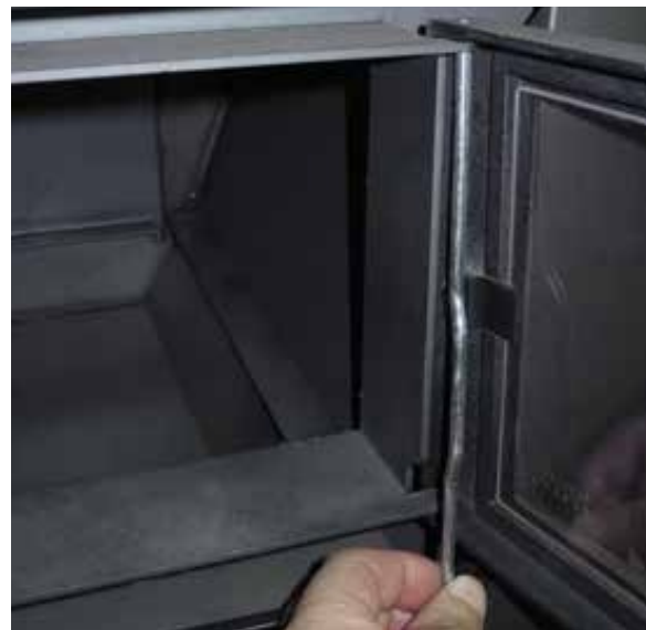
Figure 7. Ouvrez la porte et soulevez l'axe de charnière pour qu'il sorte du barillet de charnière inférieur.
